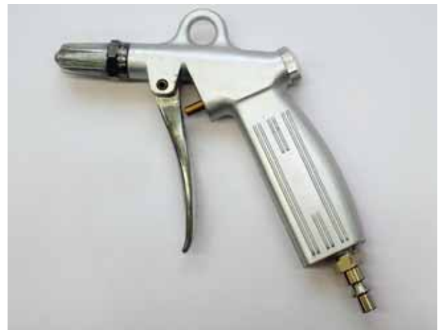
Bild 1: Blaspistole mit Mehrlochdüse.
